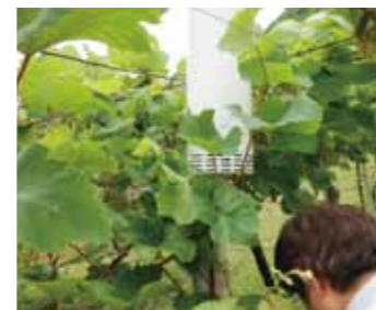
圃場のフィールドサーバー 気温の変化を観測し、有効積算温度の調査を実施しました。
